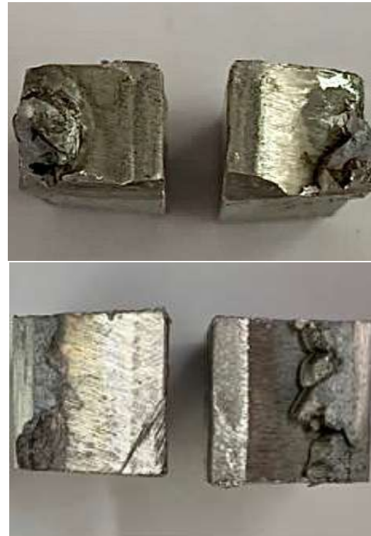
Gambar 5. Penampakan visual spesimen kampuh tirus tunggal.
