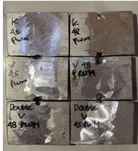
Gambar 2. Spesimen uji kekerasan.
