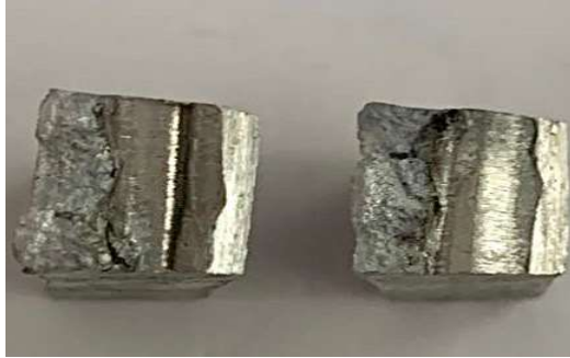
Gambar 7. Penampakan visual spesimen kampuh V ganda.
