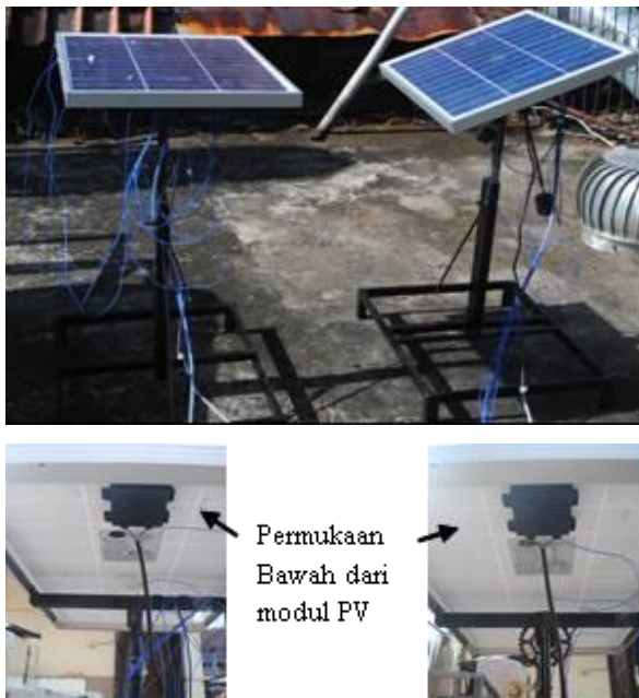
Gambar 1 Modul PV tipe polycrystalline silicon dengan dan tanpa pengarah matahari
