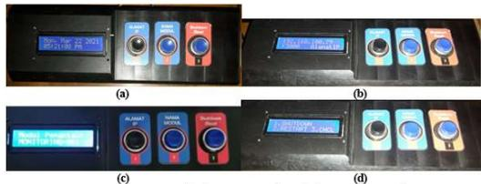
Gambar 13. Tampilan layar LCD (a) tampilan default, (b) tampilan alamat IP, (c) tampilan nama modul dan (d) tampilan menu restart/off.
