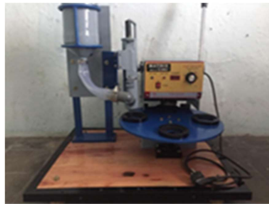
Gambar 4. Mesin sealer cup yang telah dimodifikasi.
