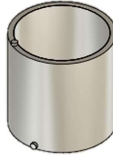
Gambar 1. Desain panci kukus alat pengasin telur otomatis.
