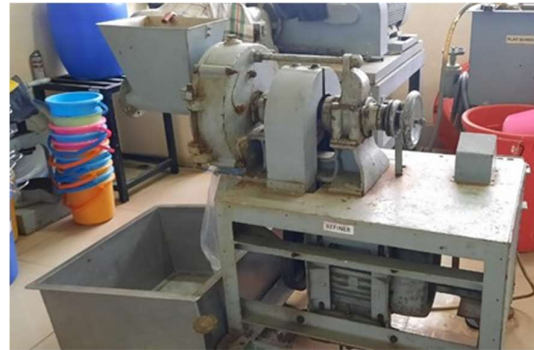
Gambar 1. Refiner pada proses mechanical pulping.
