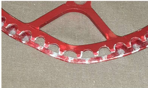
Gambar 2. Deformasi pada sprocket.
