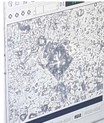
Gambar 4. Titik pengujian kekerasan vickers.
