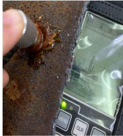
Gambar 3. Pengukuran tebal menggunakan jangka sorong, mikrometer, dan ultrasonic thickness gauge.
