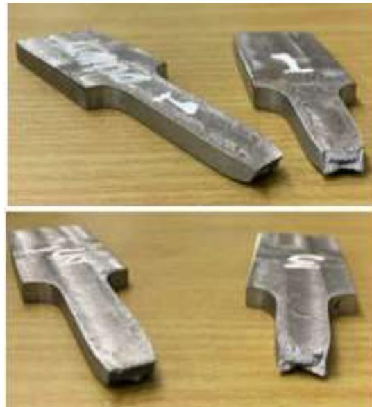
**Gambar 5.** Spesimen lama dan baru setelah dilakukan uji tarik.
