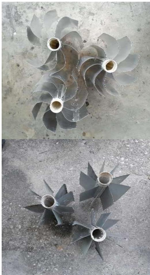
Gambar 3. Impeller yang digunakan.
