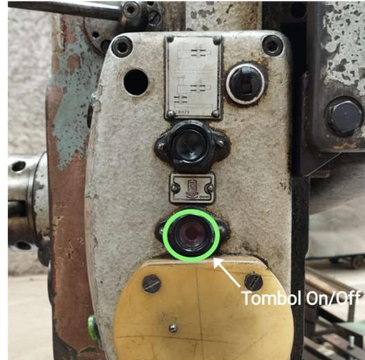
Gambar 3. Tombol daya mesin bor radial.
