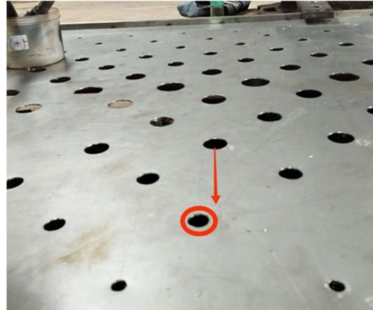
Gambar 7. Kesalahan posisi dan jarak lubang.
