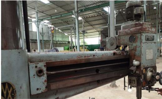
Gambar 2. Mesin bor radial tipe Csepel RF 22/B.
