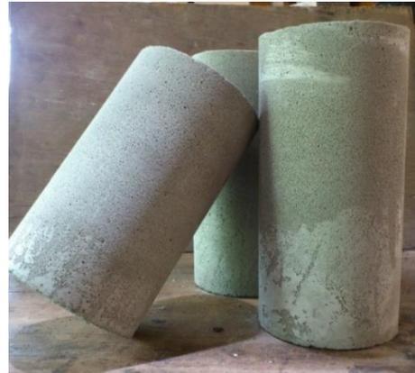
Gambar 7. Hasil Produk Spesimen Uji Hasil Pengujian Berat Jenis
