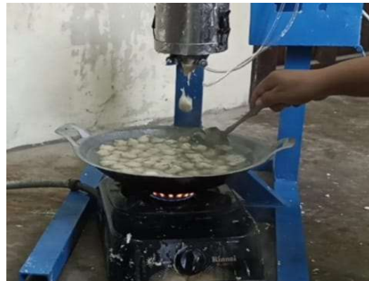
Gambar 3. Proses pencetakan bakso menggunakan mesin pencetak bakso berbasis pneumatik.
