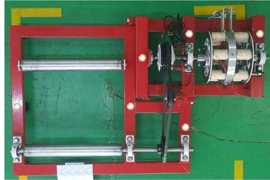
Gambar 5. Hasil pabrikan rangka dengan komponen yang telah ditempatkan pada rangka.
