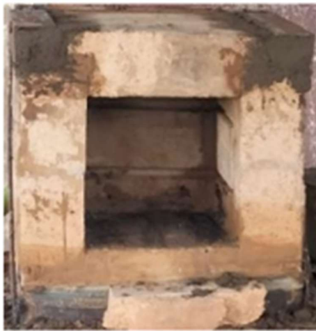
Gambar 5. Proses pelapisan menggunakan semen castable c16.
