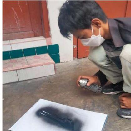
**Gambar 9.** Finishing dengan pengecatan pada angle pad.
