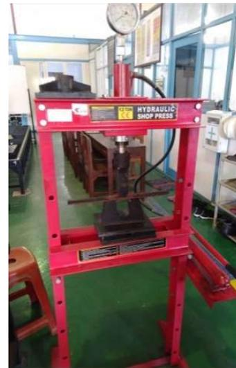
Gambar 1. Hidrolik press 12 ton.
