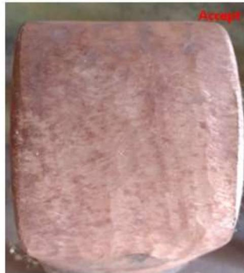
Gambar. 6. Hasil uji bending spesimen.
