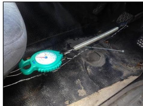
Gambar 10. Setup Dinamometer.
