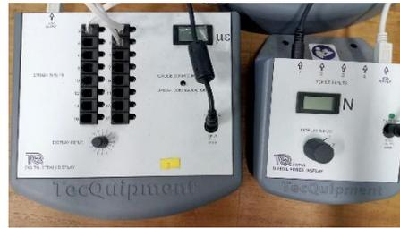
**Gambar 2.** Panel indikator gaya dan *digital strain display* dari alat *existing*
