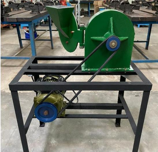
Gambar 3. Belt dan Pulley Mesin Crusher
