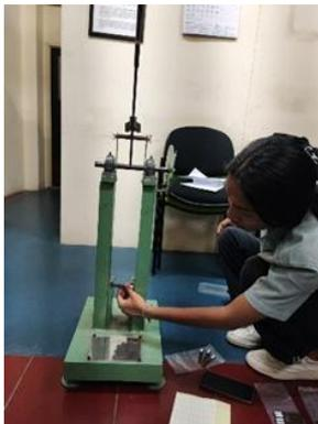
Gambar 17. Letakkan spesimen diatas penompang
