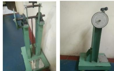
**Gambar 1.** Alat uji impak
