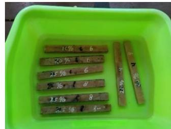
Gambar 3. Pengujian Daya Serap Air Laut
