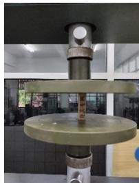
Gambar 1. Pengujian Uji Tekan
