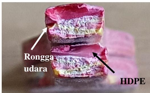
Gambar 4. Foto Uji Makro Spesimen 1
