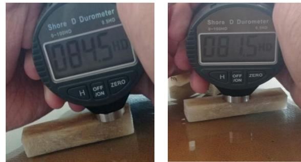
Gambar 15. Proses Pengujian Spesimen Pada Uji Kekerasan Shore D
