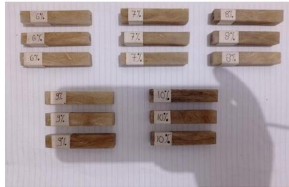
Gambar 14. Spesimen Uji Kekerasan Shore D
